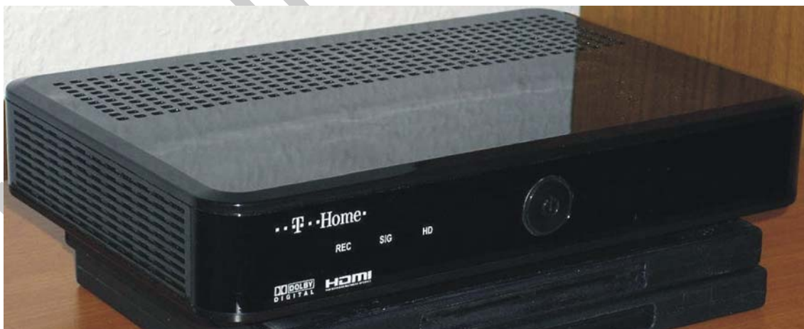
14. ábra. A másodlagos IPTV vevőegység előlapja
