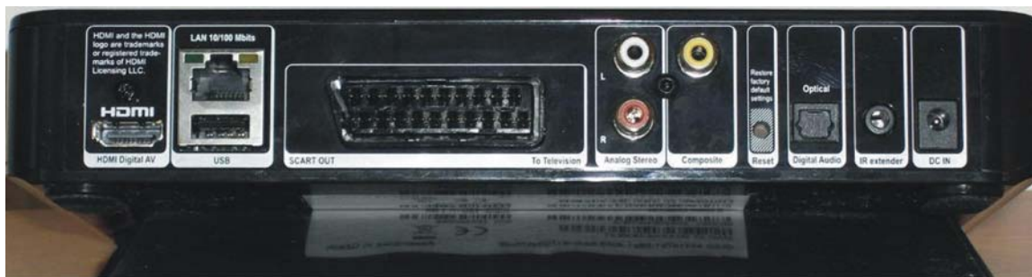
15. ábra. A másodlagos IPTV vevőegység hátlapján található csatlakozók
