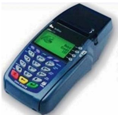
16. ábra. POS terminál, amely ISDN D-csatornán X.25 protokollal is működtethető
