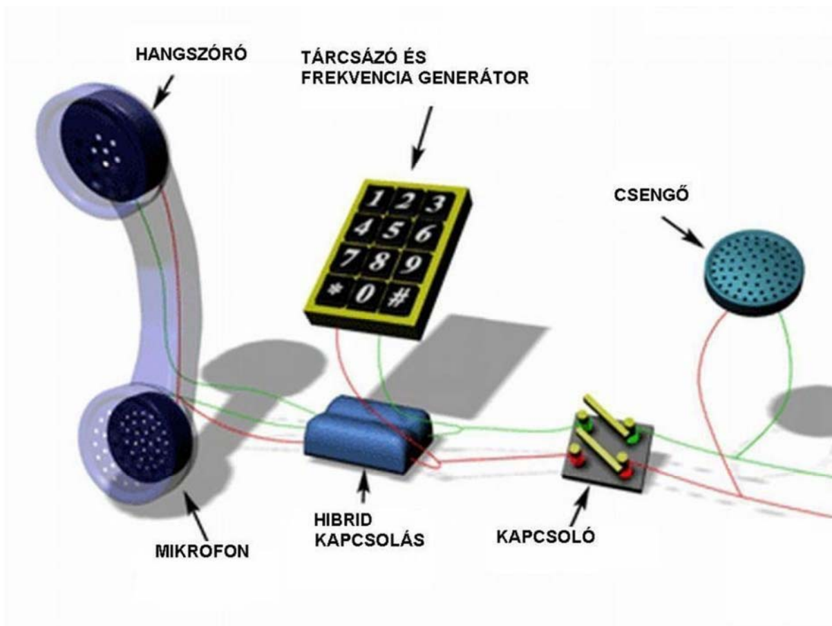
3. ábra. A telefonkészülék felépítése 2
