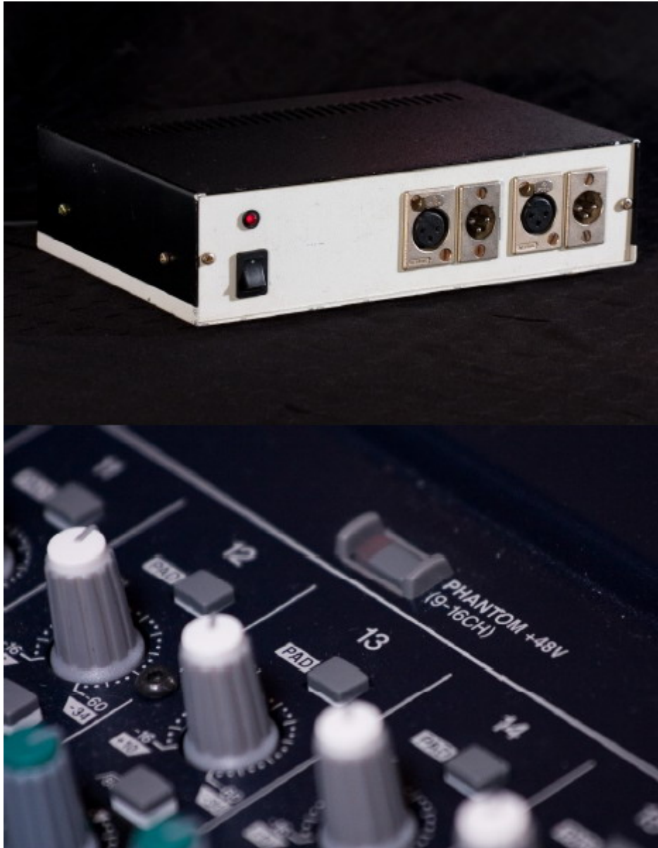
7. ábra. Fantom tápellátás biztosítása 7
