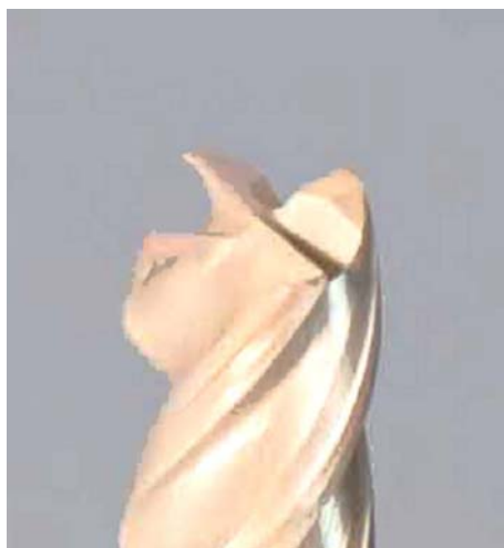
12. ábra. Hosszlyukmaró keresztélének kialakítása
