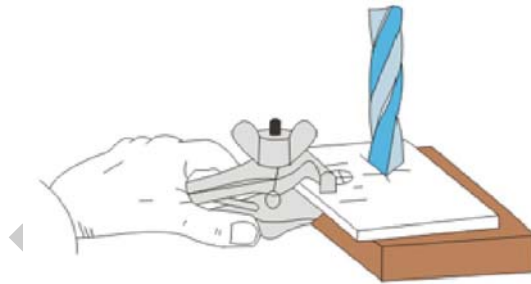
6. ábra. Sikattyú használata asztali és oszlopos fúrógépen
