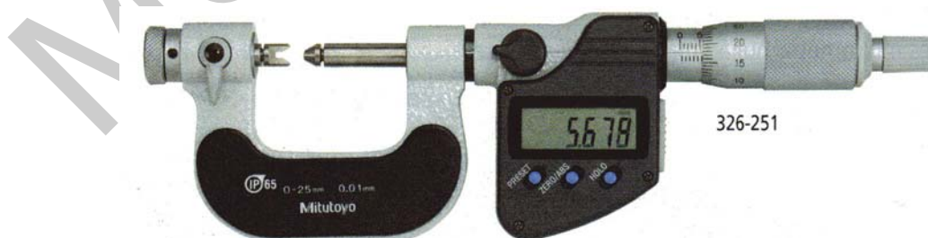
13. ábra. Digitális kengyeles mikrométer különleges betétekkel 10
