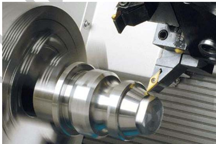
1. ábra. Tengelyszerű alkatrész megmunkálása CNC esztergagépen
