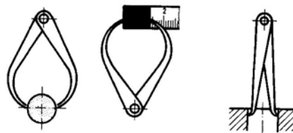
3. ábra. Külső és belső mérőkörző 2
