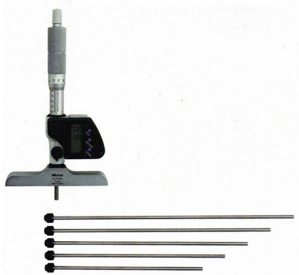
13. ábra. Digitális mélységmérő mikrométer cserélhető mérőbetétekkel 12
