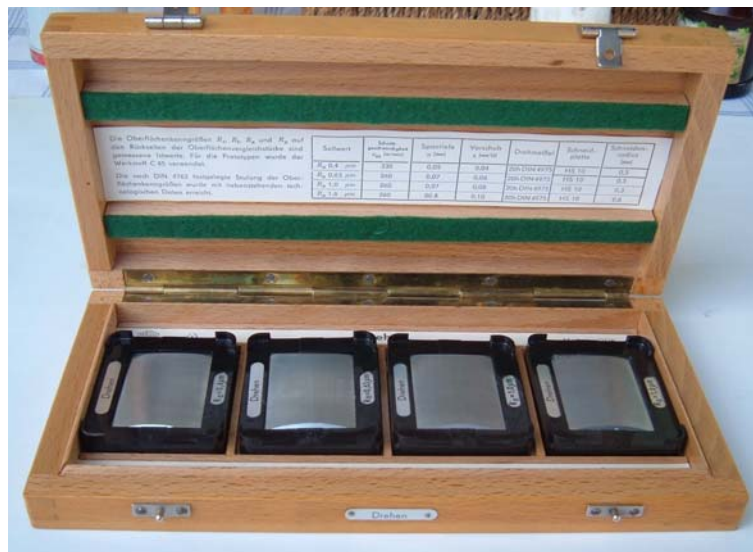
24. ábra. Érdességi etalonok fadobozban
