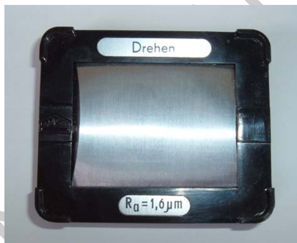
25. ábra. R_a 1,6-os érdesség minta
