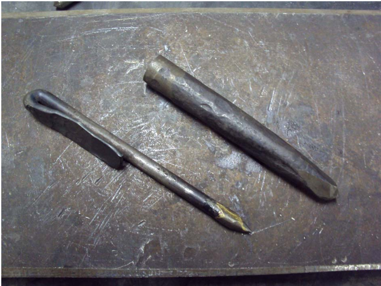
9. ábra: Házilag készített rajztű és pontozó
