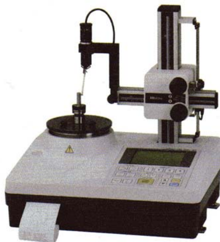
15. ábra. Kompakt asztali köralak mérő készülék 12
