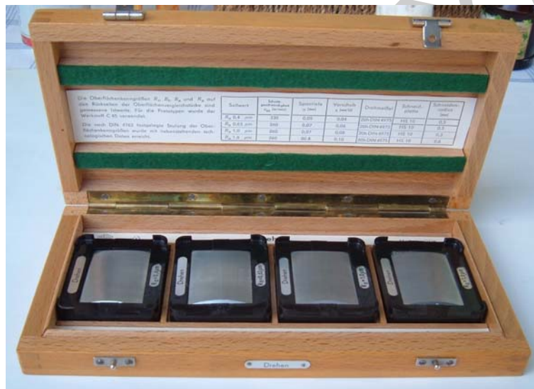
46. ábra Felületi érdesség minták fadobozban
