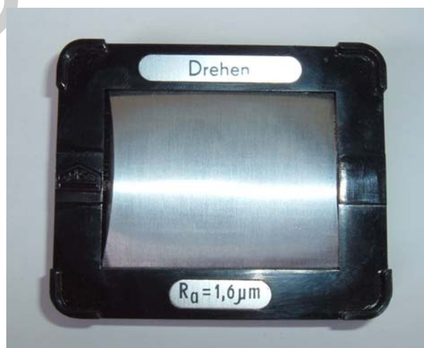
47. ábra R_a 1,6-os érdesség minta
