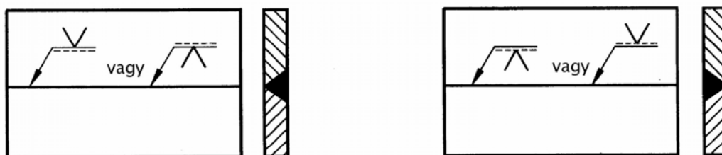
55. ábra. Hegesztési varrat elhelyezése a rajzon
