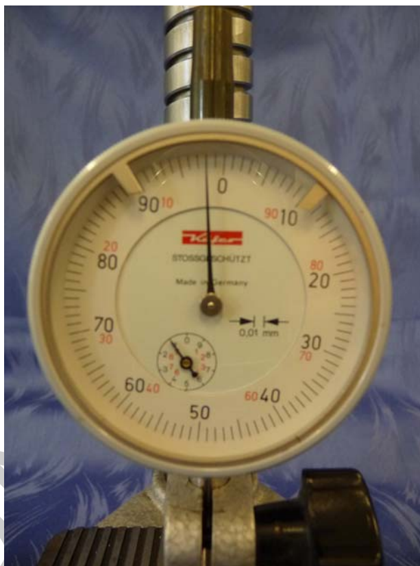
24. ábra. A mérőóra felépítése 21
