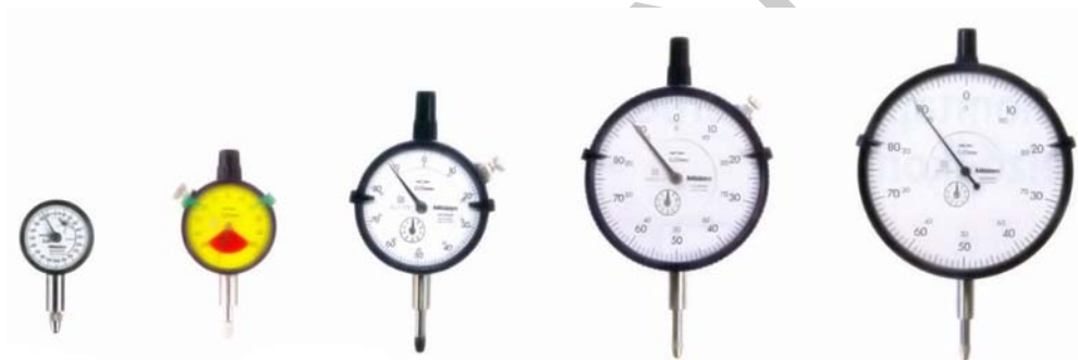
4. ábra. Analóg mérőórák 4
