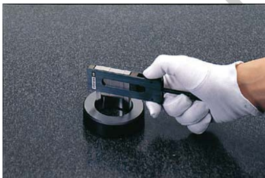
15. ábra. Beállító gyűrű méretének ellenőrzése mérőhasábbal 15
