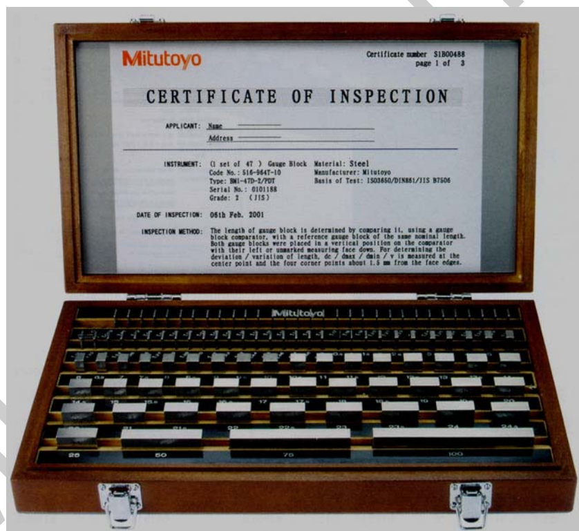
11. ábra. 103 darabos mérőhasáb-készlet 11
