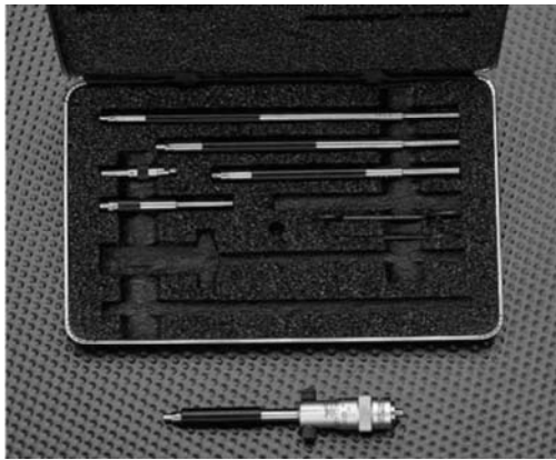
55. ábra. belső furatok mérésére szolgáló mikrométer készlet
