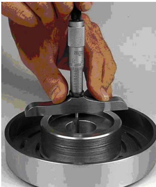
57. ábra. Mélységmérő mikrométer alkalmazása
