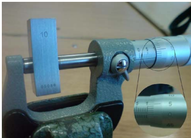
53. ábra. Mikrométer pontosságának ellenőrzése mérőhasábbal
