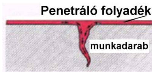
7. ábra. Penetráló jelzőfolyadék nedvesítő hatása
