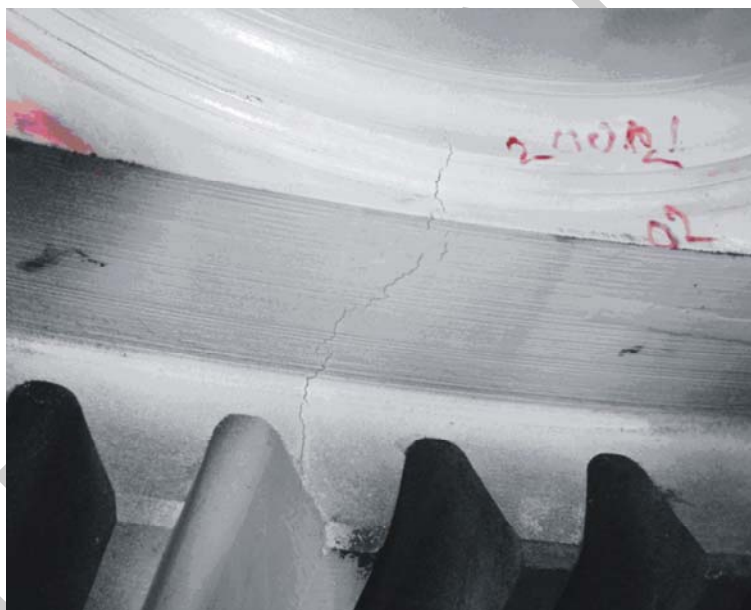
24. ábra. Színkontrasztos (fekete-fehér) mágnesezhető poros vizsgálat
