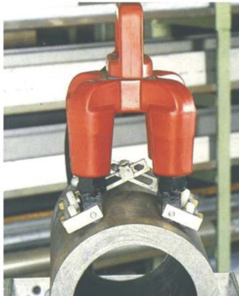
21. ábra. Hordozható mágneses repedésvizsgáló berendezés
