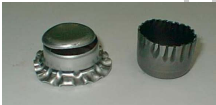
14. ábra. Mélyhúzási hibák: ráncosodás
