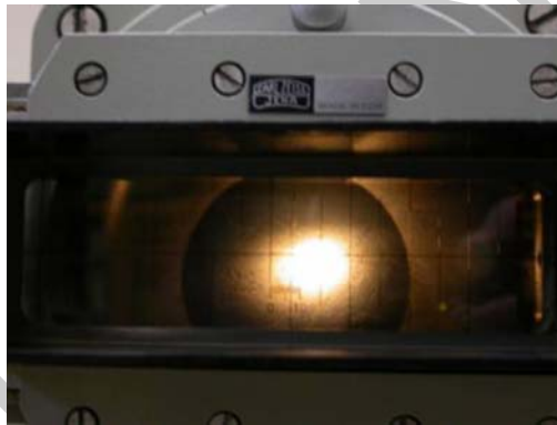
3. ábra. A lenyomat mérése Brinell keménységmérésnél
