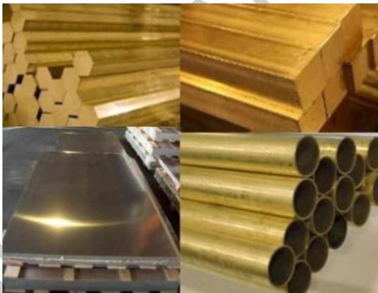
10. ábra. Sárgaréz félgyártmányok: rudak, szalag, cső 10
