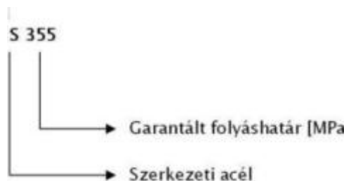
13. ábra. Szerkezeti acélok jelölése
