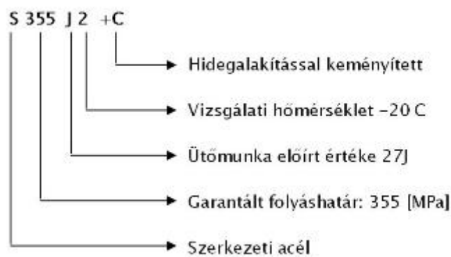
17. ábra. Az acélok szállítási állapotára utaló jelölések
