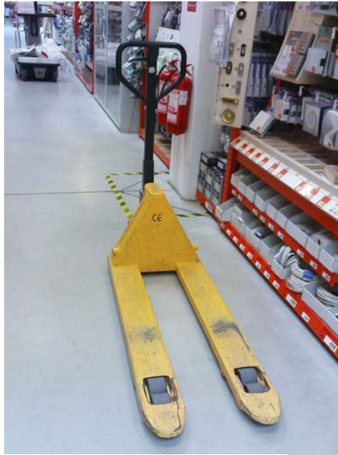
12. ábra Kézi szállítótargonca ("béka")
