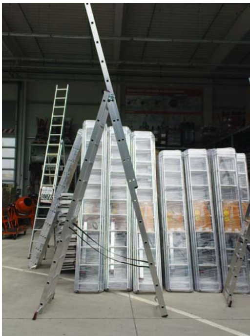
6. ábra. Kétágú létra kitolható hosszabbítóval
