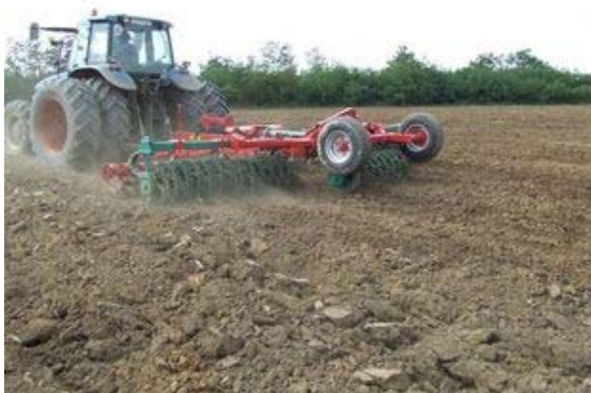
6. ábra. A talaj tömörítése 7
