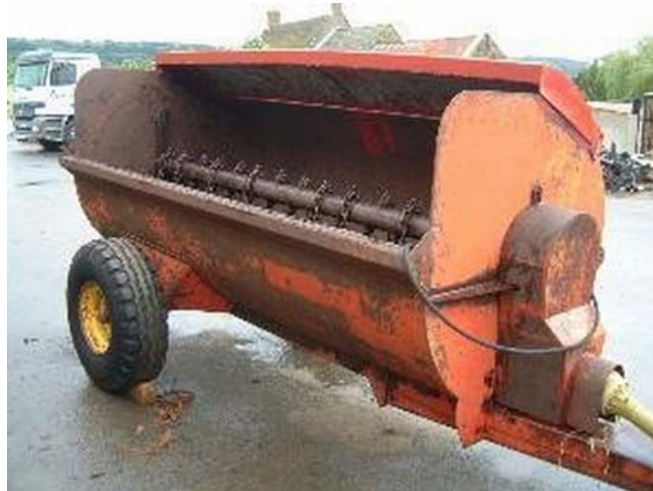
11. ábra. Marshall típusú oldalra szóró szerves trágya kijuttató eszköz 19
