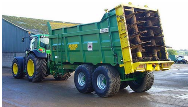
10. ábra. FBS12 függőleges tengelyelrendezésű szervestrágya-szóró 17
