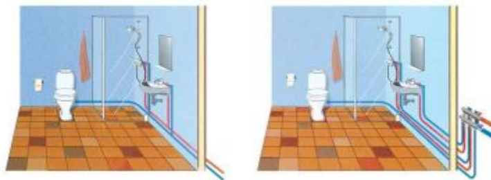
2. ábra. Wirsbo vezeték T-elágazással, illetve osztóval-gyűjtővel szerelve 3
