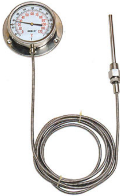
7. ábra. Nyomásváltozáson alapuló hőmérő
