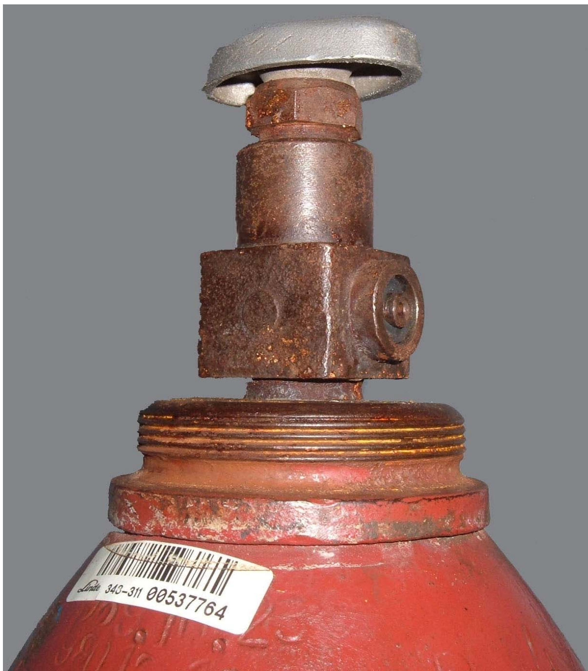
6. ábra. Disszugázipalack szelepe
