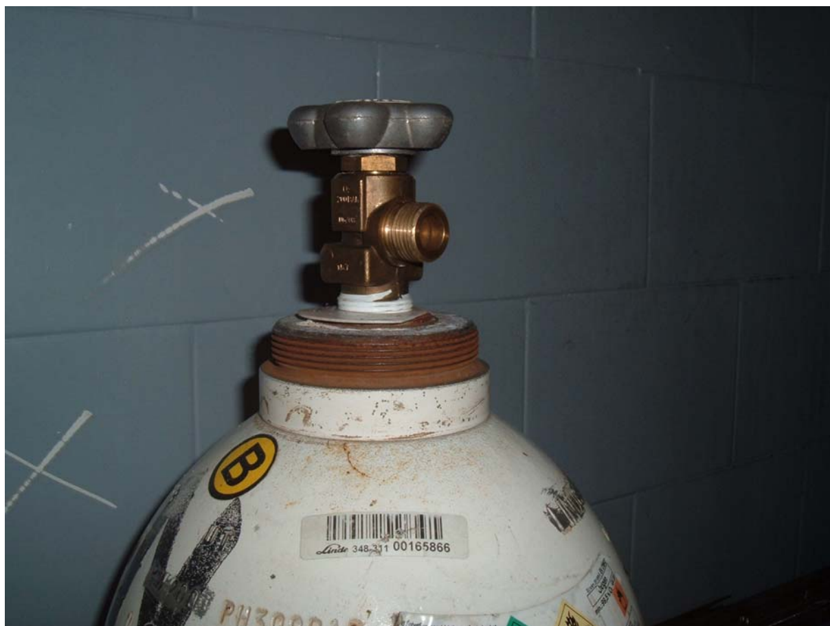
5. ábra. Oxigénpalack zárószelepe
