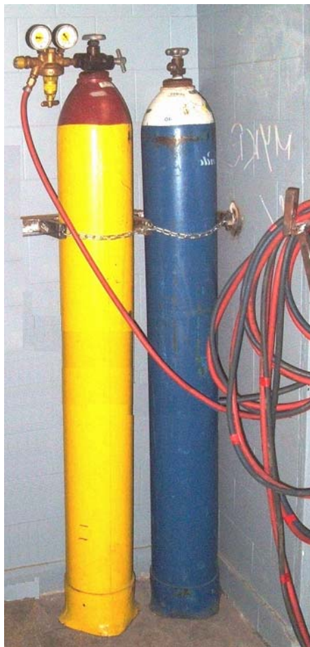
4. ábra. Oxigénpalack és disszugáz palack színe
