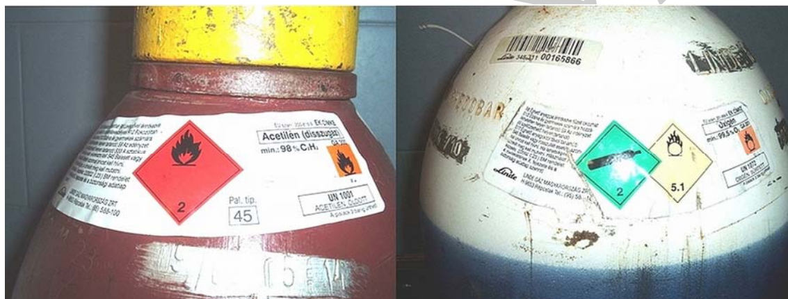
3. ábra. A disszugáz palack és az oxigénpalack matricája
