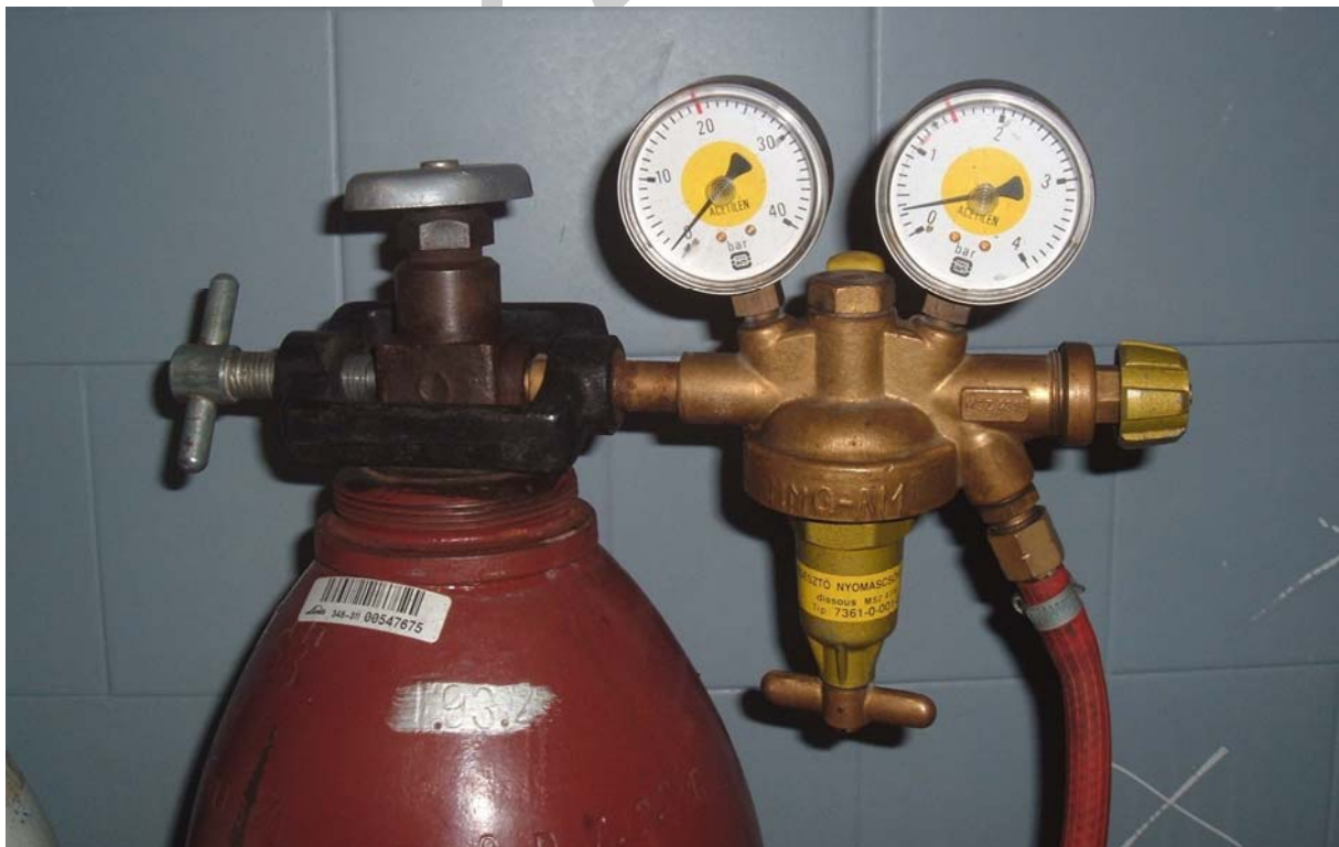
7. ábra. Acetilén gáz nyomáscsökkentője
