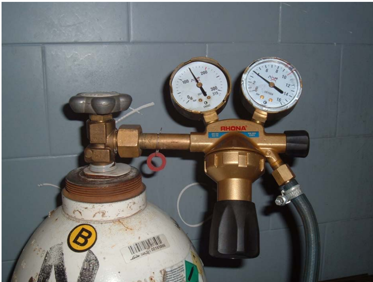
8. ábra. Oxigénpalack nyomáscsökkentője
