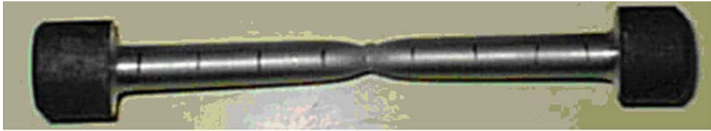
16. ábra. Elszakított próbapálca
