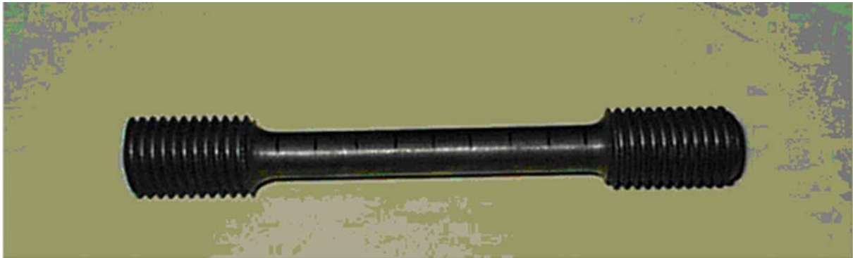
6. ábra. Menetes próbatest
