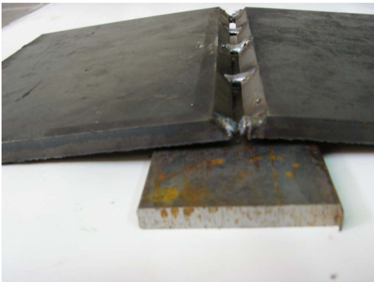
31. ábra. Szögelfordulás megakadályozása
