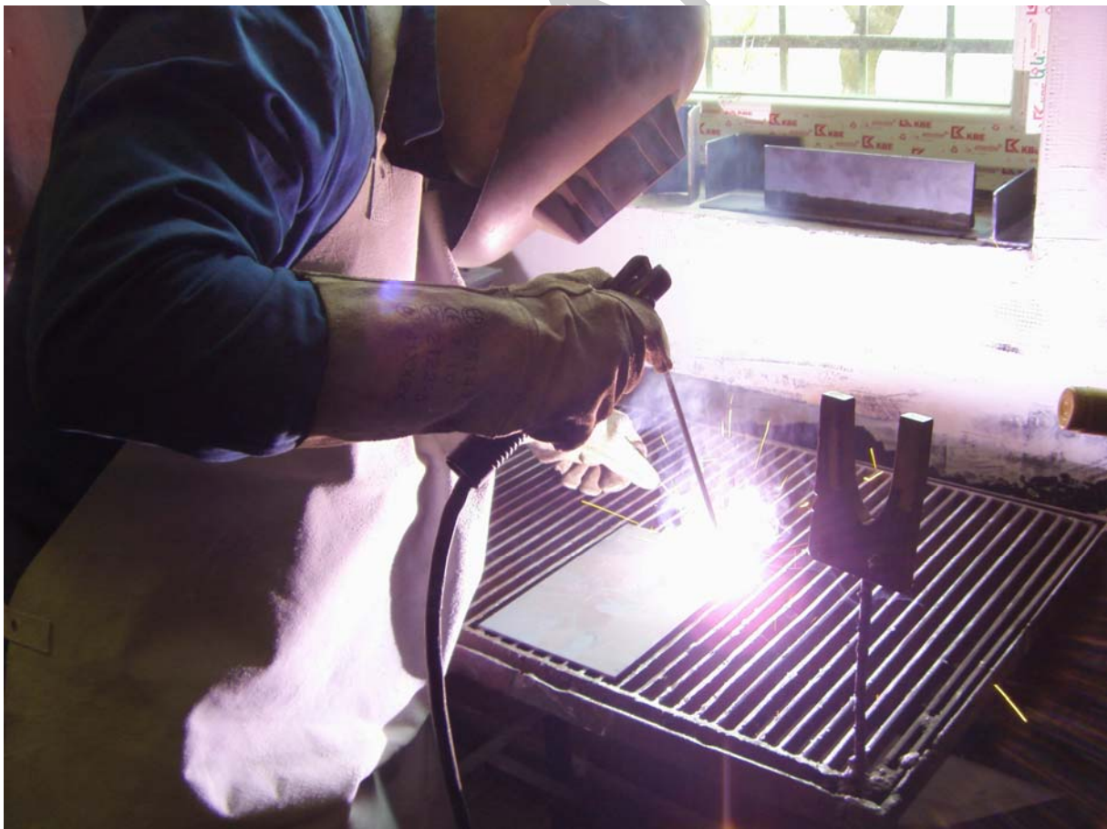
1. ábra. Bevontelektródás kézi ívhegesztés
