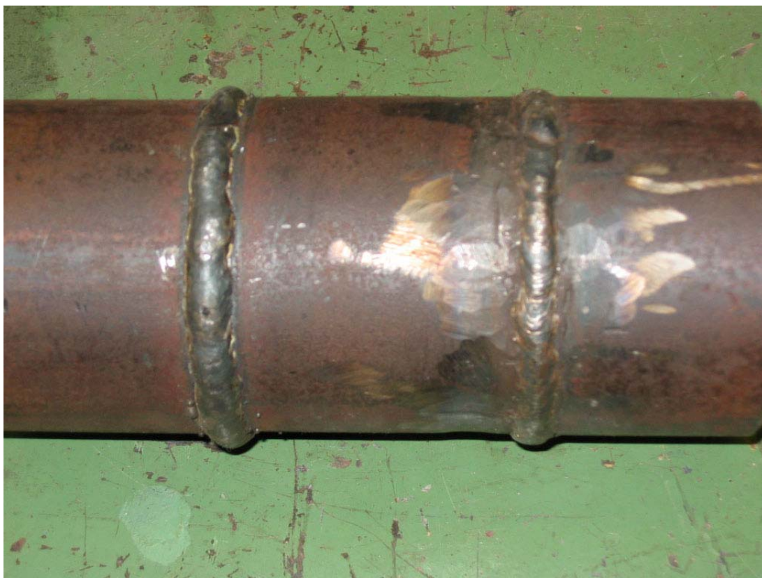
047. ábra. Varrat készítése csövön.
