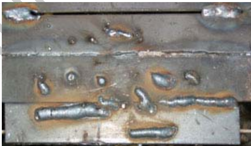
027. ábra. Helytelenül tartott és vezetett elektróda által készített varrat képek.
