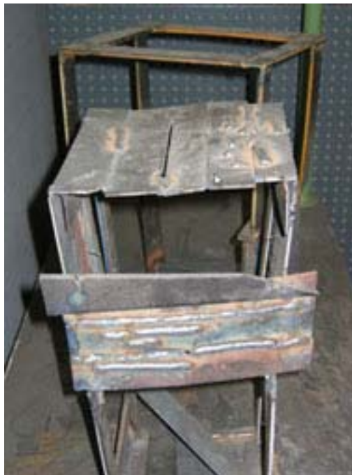
026. ábra. Hegesztési gyakorlat, különböző varrat helyzetekben.
