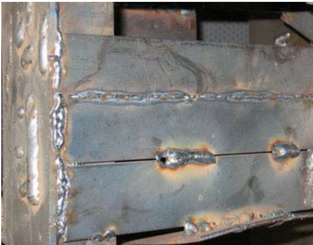
023. ábra. függőleges síkban fekvő vízszintes varrat
