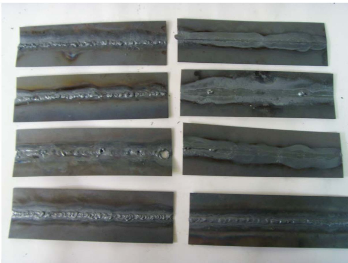
28. ábra. Gázhegesztéssel készült leggyakoribb varrathibák
