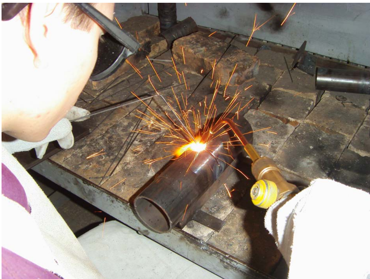
27. ábra. Forgatható, vízszintes tengelyű cső hegesztése
