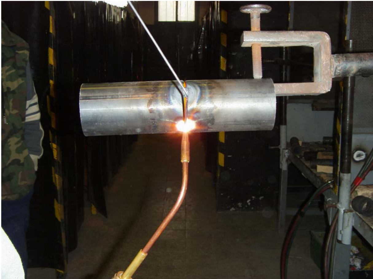
26. ábra. A rögzített, vízszintes tengelyű csövek hegesztése
