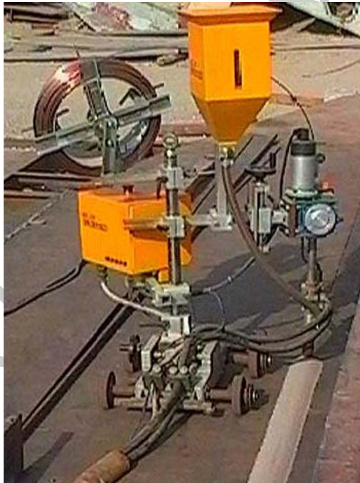
5.ábra. Fedett ívű hegesztő berendezés hegesztési varrat készítése közben
