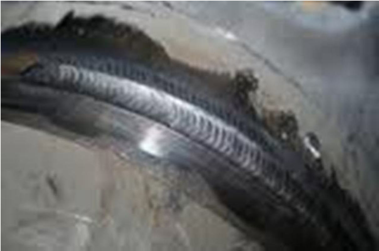
5. ábra. Korrózióálló acél fogyóelektródás védőgázos ívhegesztéssel készített hegesztési varrata
