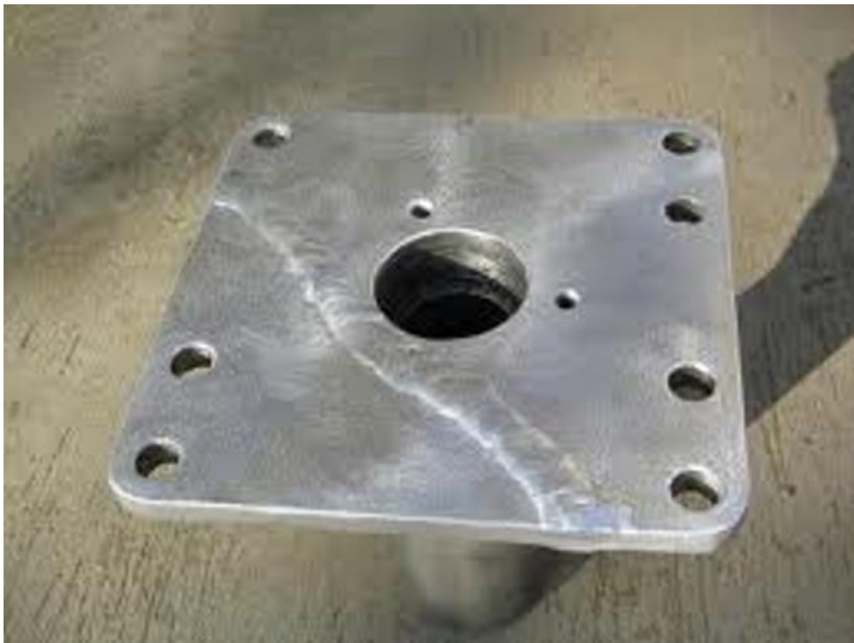
5. ábra. Alumínium öntvény javító hegesztése
