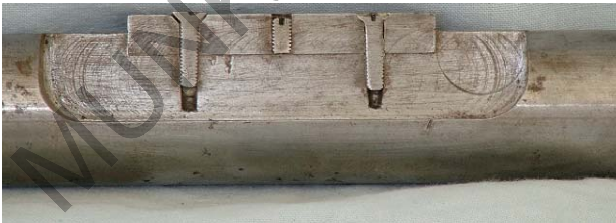
37. ábra. A reteszt csavarokkal erősítjük a tengelyhez
