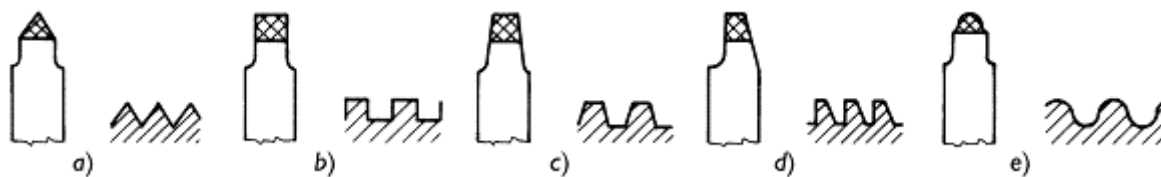
2. ábra. Menetprofilok /a) éles menet, b) laposmenet, c) trapézmenet, d) fűrészenet, e) zsinórmenet/
