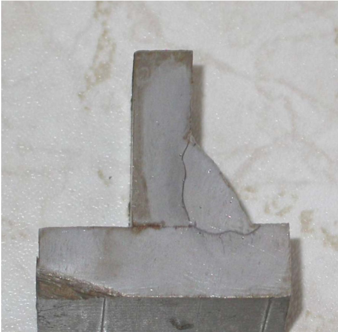
12. ábra. Hegesztési varrat keménységmérése
