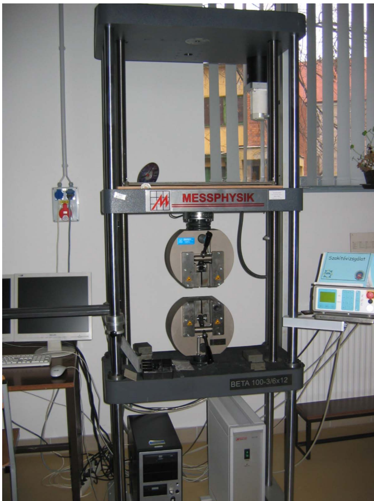
7. ábra. Szakító gép, PC vezérléssel és kiértékeléssel
