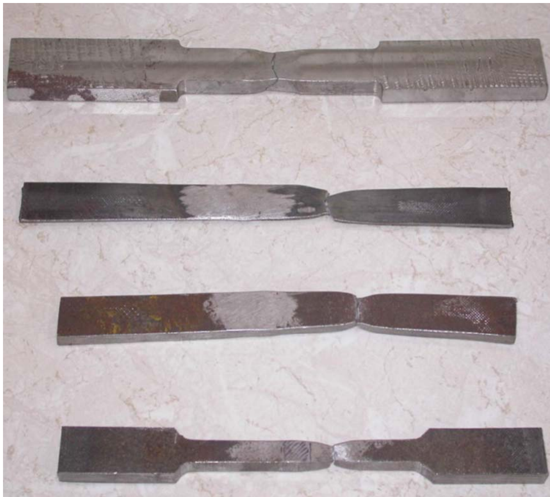
6. ábra. Hegesztés utáni szakítóvizsgálat próbatestei
