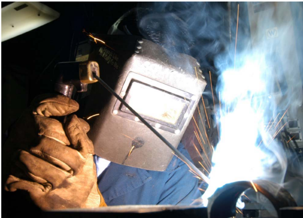
1. ábra. Bevontelektródás kézi ívhegesztés
