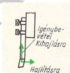
4. ábra. A vésőkés igénybevétele
