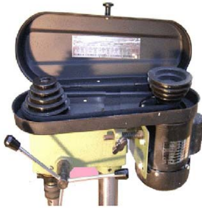
5. ábra. Fúrógép hajtása több áttételű ékszíjtárcsákkal
