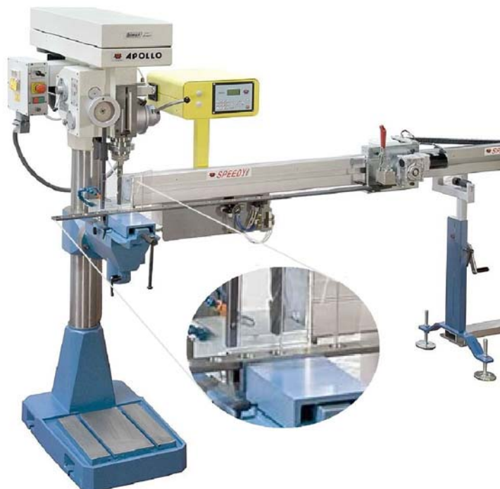
17. ábra. Oszlopos fúrógép léptető-adagoló pályával egybeépítve
