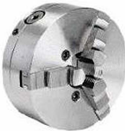
12. ábra. Hárompofás tokmány a munkadarab rögzítéséhez
