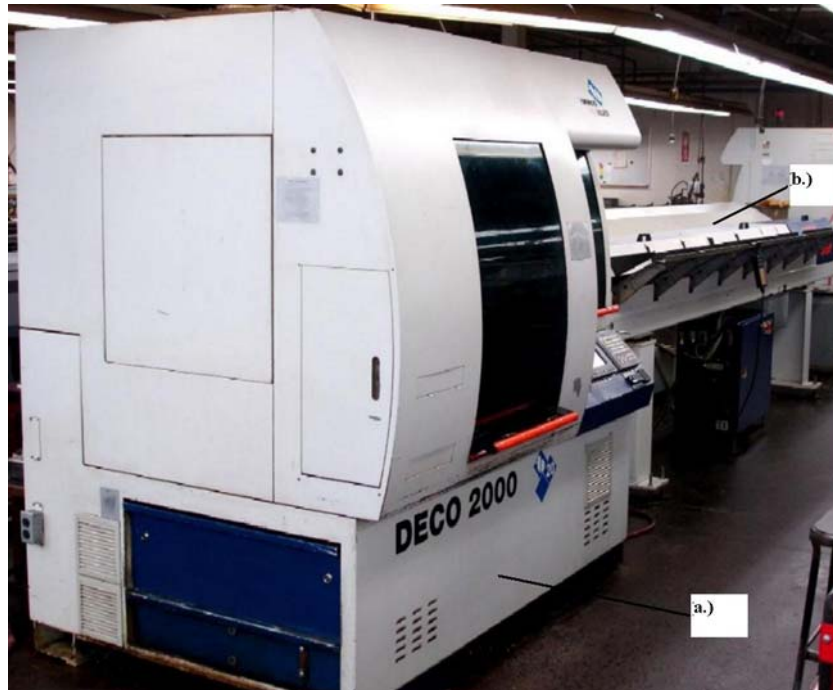
3. ábra. Szálvezető gép: a.) Megmunkálógép, b.) Szálvezető
