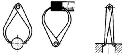
3. ábra. Külső és belső mérőkörző 2
