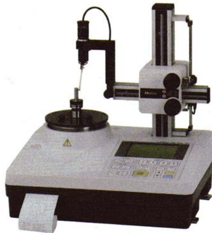
31. ábra. Kompakt asztali köralak mérő készülék 30
