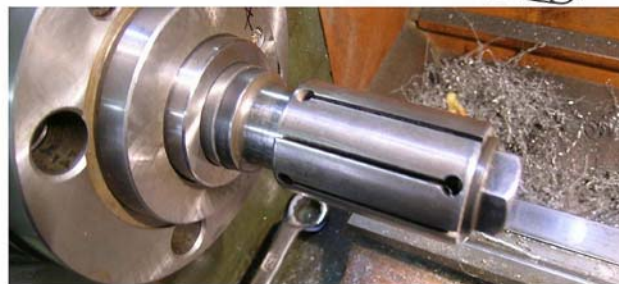
15. ábra. Szorítópatron és alkalmazása
