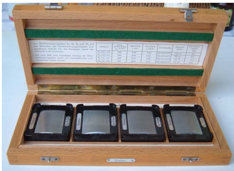
24. ábra. Érdességi etalonok fadobozban
