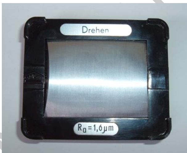
25. ábra. R_a 1,6-os érdesség minta
