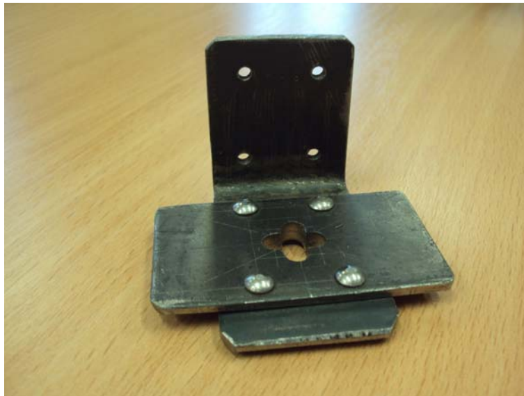
2. ábra: Síkbeli előrajzolás segítségével készített alkatrész
