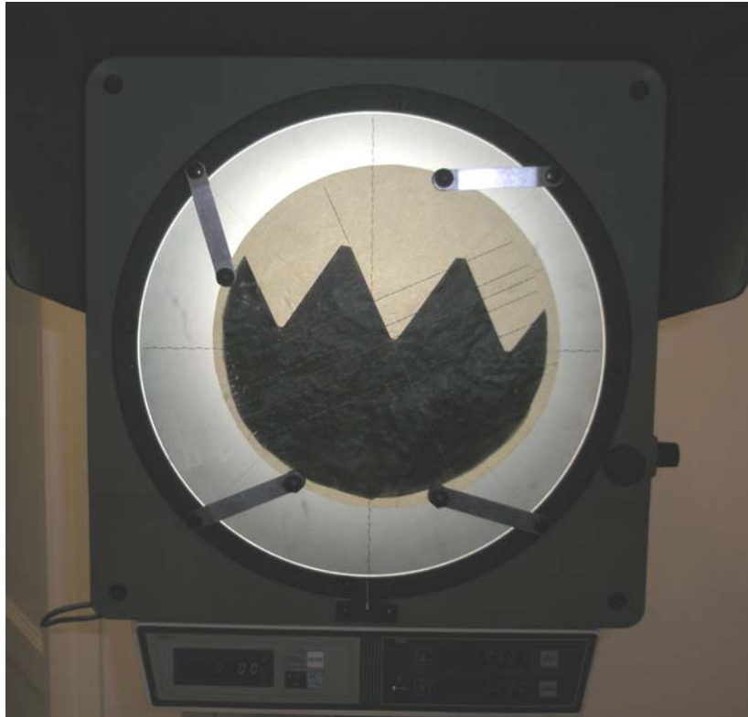
15. ábra. Profilellenőrzés projektorral
