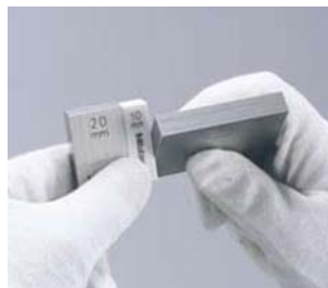
14. ábra. Mérőhasábok összeillesztése kézzel 14
