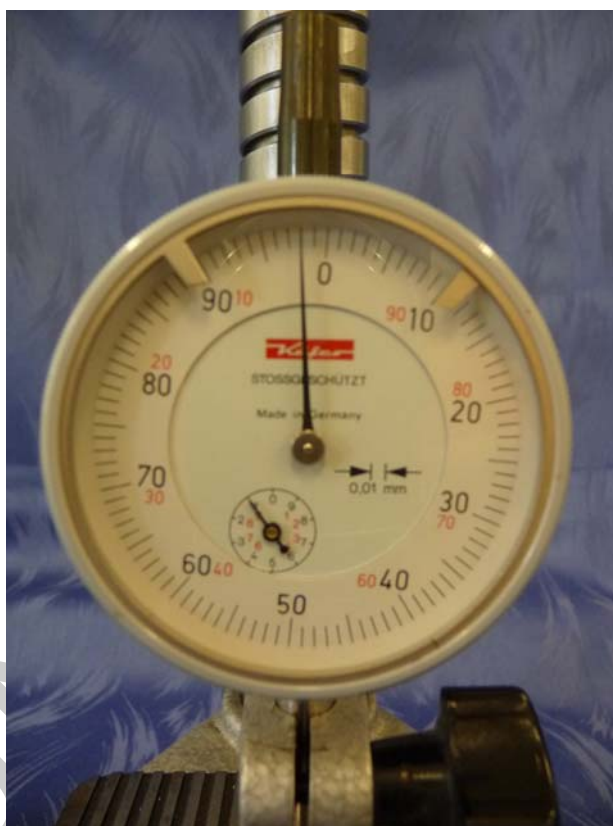
24. ábra. A mérőóra felépítése 21
