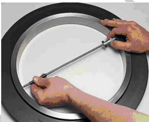
58. ábra. Két ponton mérő furatmérő mikrométer használata
