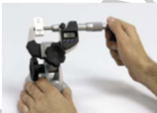
51. ábra. Mikrométer pontosságának ellenőrzése mérőhasábbal
