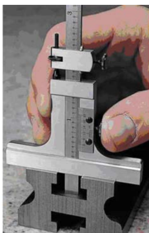
46. ábra. Mélységmérő tolómérők alkalmazása
