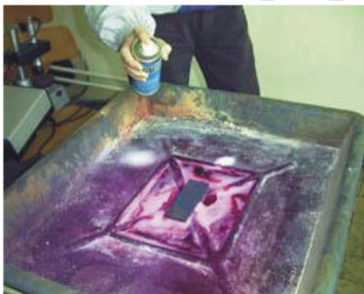
5. ábra. Alkatrész tisztítása oldószerrel
