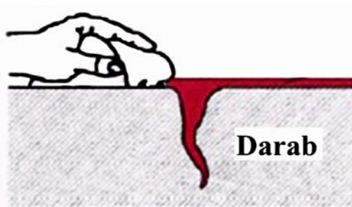
8. ábra. Fölösleges behatoló folyadék eltávolítása
