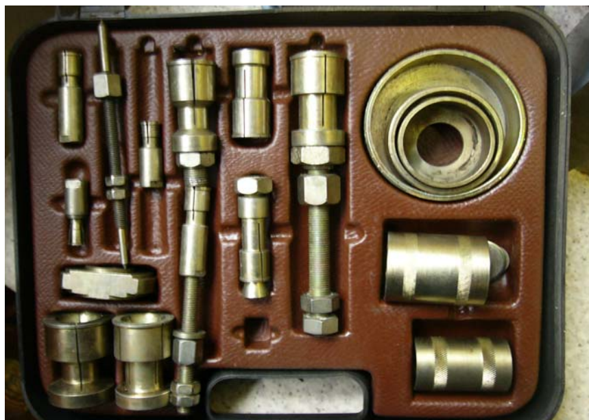
24-es ábra. Csapágszerelő készlet csapágházból való kiszéréséhez.
